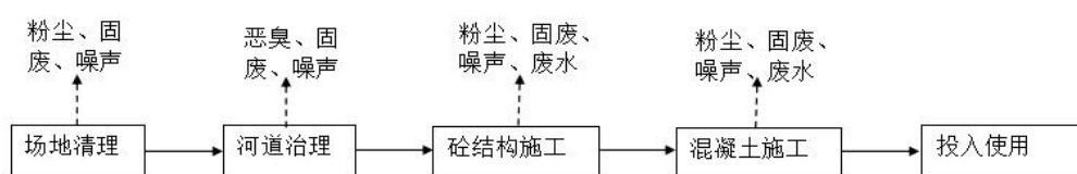
图8 项目河道护岸工程施工流程图
