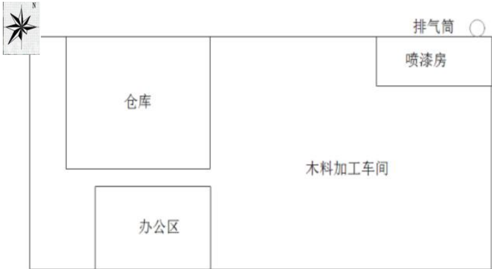
附图 2 生产车间平面布置图
