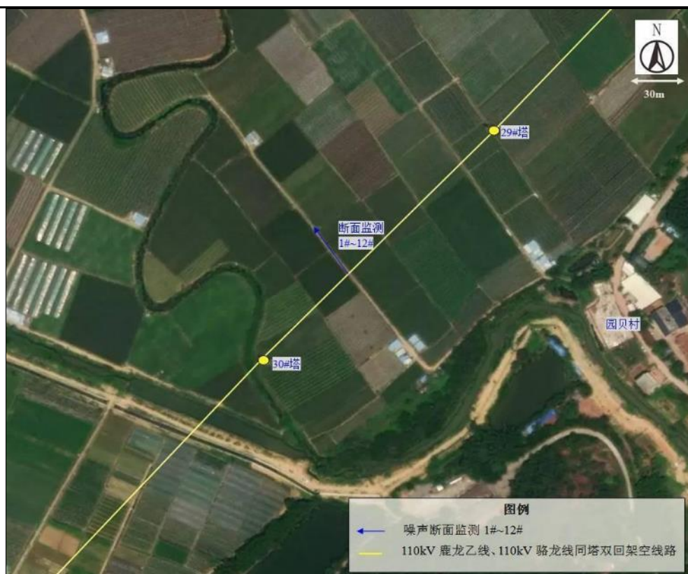
图 4.2-2 惠州 110kV 鹿龙乙线、110kV 骆龙线同塔双回架空线路监测布点图 运行工况：监测期间运行工况见表 4.2-5。
