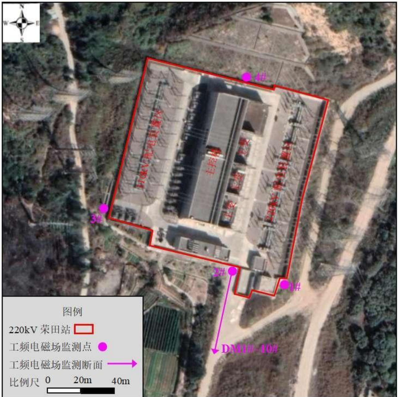
图 8.2-4 220kV 荣田变电站监测布点图
