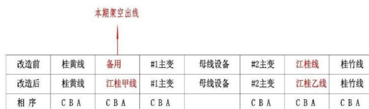
图 2.2-2 110kV 桂田站 110kV 进出线间隔布置图
