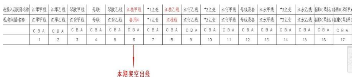
图 2.2-1 220kV 琴江站 110kV 进出线间隔布置图
