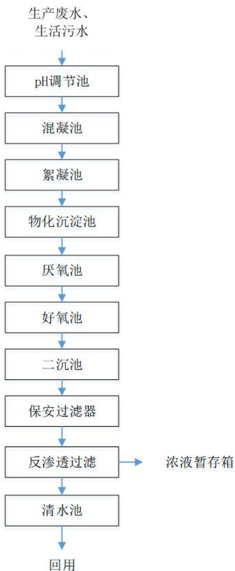
图 4-1 项目废水处理工艺流程图
