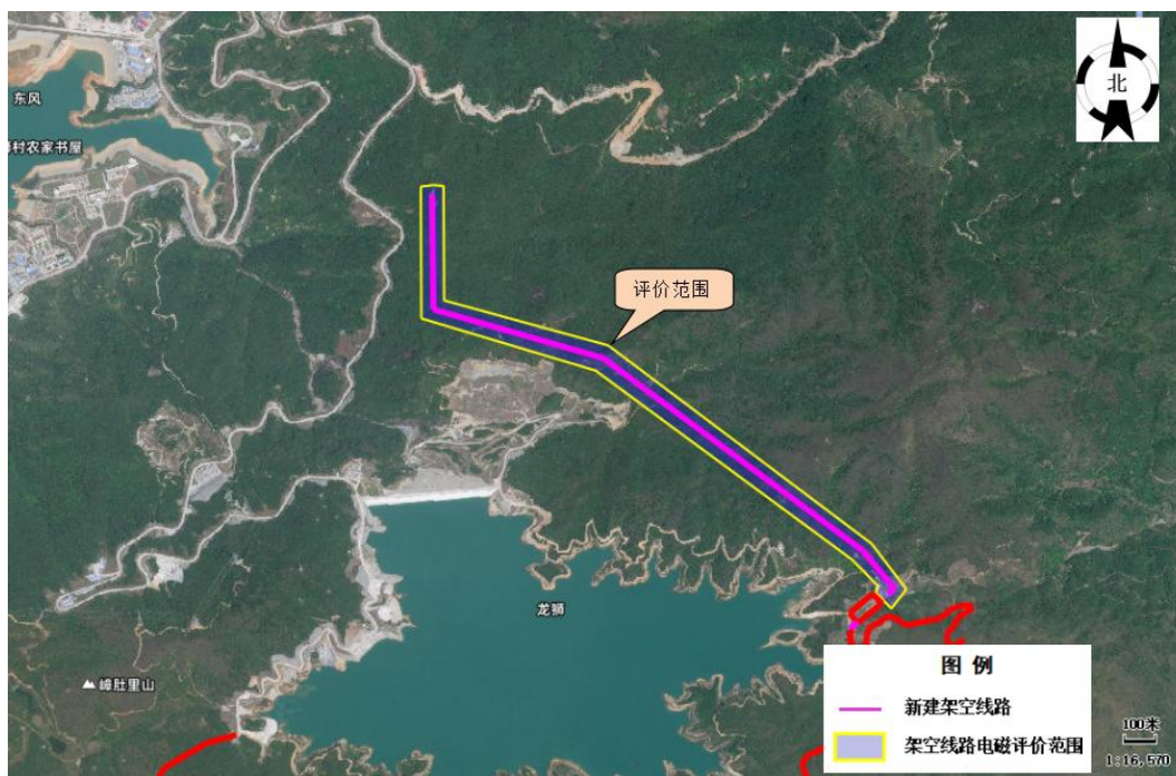
图2 架空线路电磁评价范围图（架空线路边导线地面投影外两侧 30m）
